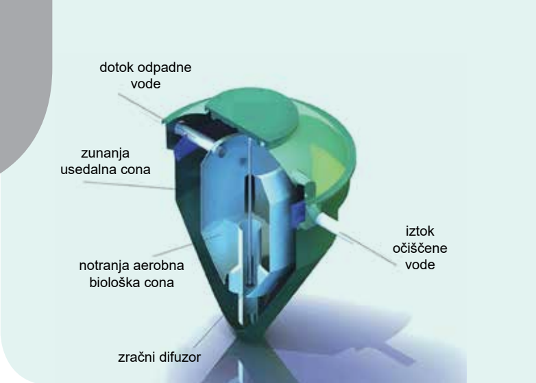
Pretlačna čistilna naprava s suspendirano biomaso.
